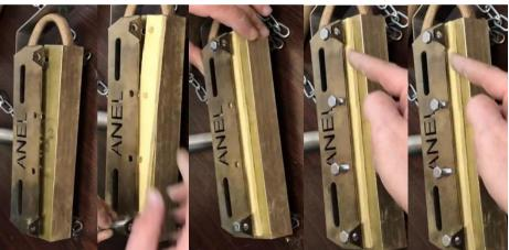
Empurre a cabeça de marcação de volta ao lugar e interrompa os isoladores entre os suportes da base e a cabeça de marcação. Tenha cuidado, o material de isolamento é muito frágil. Insira os 4 parafusos.
