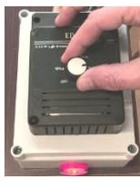
Appuyez sur l'interrupteur central du régulateur de température en position « I ». Le voyant lumineux s'allume.
