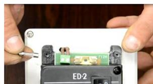
être remplacé, ôtez l'ancien fusible en le soulevant doucement avec un tourne-vis, jusqu'à ce qu'il soit libéré. Tirez ensuite doucement pour l'extraire.
