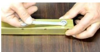
Desserrez la vis à l'arrière de la tête . Elle permet de conserver la résistance en place.
