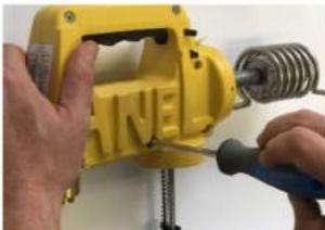
13. Coloque o regulador de fluxo de gás no lugar e aperte o parafuso lateral que o mantém no eixo de bronze da válvula.
