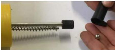
4. Desaparafusar (para a esquerda) o pistão da bomba. **ATENÇÃO**, dentro há outra bola, não a perca (o sistema de bombeamento funciona com esta bola)
