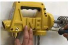
6. Remova a metade superior do revestimento de modo que o interior do vaporizador possa ser visto.
