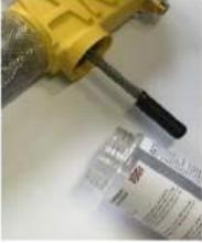
2. Remova os parafusos de suporte (2) dos dois lados do protetor e, em seguida, remova o bico de pulverização do tubo espiral.
