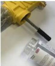
2. Aperte a parte inferior do sistema de bombeamento (copo) com uma mão e com o outro o pistão que move o copo (com a mola) para separar um do outro.
