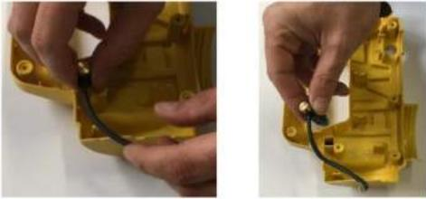
8. Remova a vela de ignição antiga e substitua-a por uma nova. Certifique-se de que o cabo de alimentação está no local onde o tubo espiral também passa de modo que, ao montar o dispositivo, a extremidade desencapada do fio da vela de ignição está em contato com o tubo em espiral.
