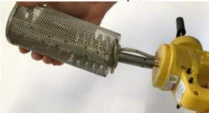
4. Desaparafuse o parafuso do regulador do fluxo de gás e depois puxe-o para removê-lo.
