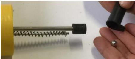
4. Schrauben Sie den Pumpenkolben (nach links) ab. **ACHTUNG**, innen gibt es noch eine Kugel, verlieren Sie sie nicht (das Pumpsystem funktioniert ohne diese Kugel nicht)
