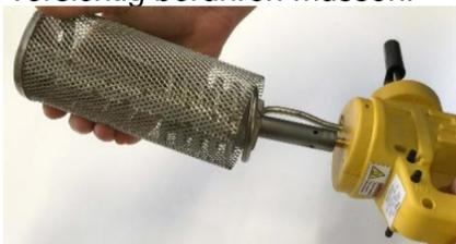
4. Lösen Sie die Schraube vom Gasflussregler und ziehen Sie sie heraus, um sie zu entfernen.
