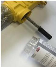
2. Entfernen Sie die Stützbolzen (2) auf beiden Seiten der Schutzhaube und entfernen Sie dann die Sprühdüse von der Spiralröhre.
