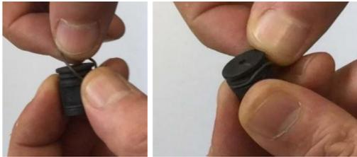
7. Legen Sie die kleine Kugel in den Kolben und schließen Sie sie. Ziehen Sie sie nicht zu fest an.
