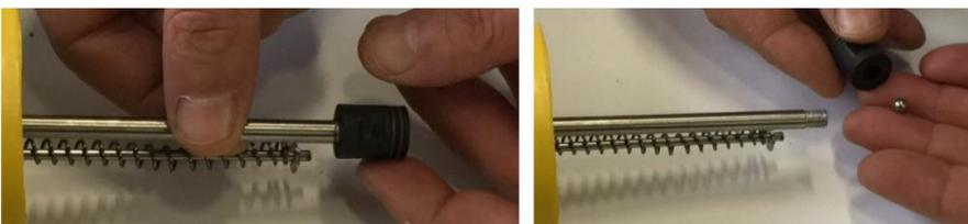
5. Entfernen Sie mit einem spitzen Holz (z. B. einem Zahnstocher) die beiden Sicherungsscheiben.
