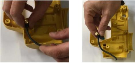
8. Entfernen Sie die alte Zündkerze und ersetzen Sie sie durch eine neue Zündkerze. Stellen Sie sicher, dass sich das Netzkabel an der Stelle befindet, an der auch das Spiralrohr verläuft, so dass das blanke Ende des Zündkerzenkabels beim Zusammenbau des Geräts in Kontakt mit dem Spiralrohr steht.
