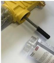
2. Ziehen Sie den unteren Teil des Pumpsystems (Becher) mit einer Hand und mit dem anderen den Kolben fest, der den Becher (mit der Feder) bewegt, um sie voneinander zu trennen.
