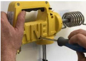
13. Stellen Sie den Gasflussregler ein und ziehen Sie die seitliche Schraube fest, die ihn an der Messingwelle des Ventils hält.
