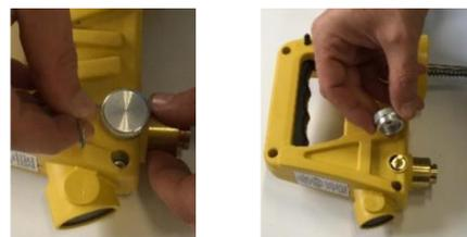
5. Legen Sie den Verdampfer auf die Seite, und entfernen Sie die Schrauben
