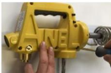
6. Entfernen Sie die obere Hälfte des Gerätes, so dass das Innere des Verneblers sichtbar wird.
