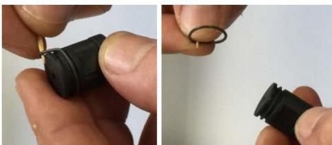
6. Installieren Sie neue Unterlegscheiben wie es in der Abbildung gezeigt wird.
