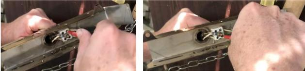
Desaperte os parafusos que estabilizam os cabos de resistência.
