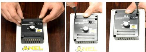
Recoloque a tampa em seu lugar e aperte os 2 parafusos que a estabilizam.
