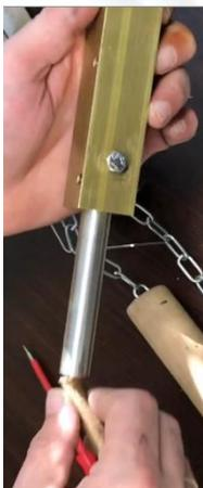
Puxe a resistência da cabeça do marcador. Verifique se há detritos no interior do buraco e, se necessário, limpe-os sem danificar o latão.
