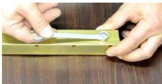
Solte (não remova) o parafuso na parte de trás da cabeça do marcador. Mantenha a resistência no lugar.
