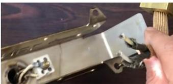
Remova a cabeça de marcação com a resistência.
