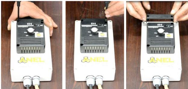
A tampa do fusível está localizada na parte inferior do regulador de calor. Está estabilizado com 2 parafusos. Solte-os e levante a tampa.
