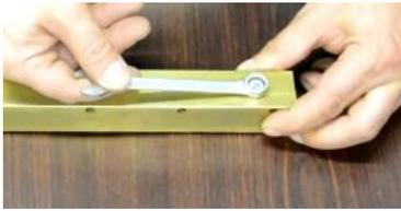
Delicadamente aperte o parafuso na parte de trás da cabeça de marcação para garantir a posição da resistência dentro. Não use muita força ou danifique a resistência.
